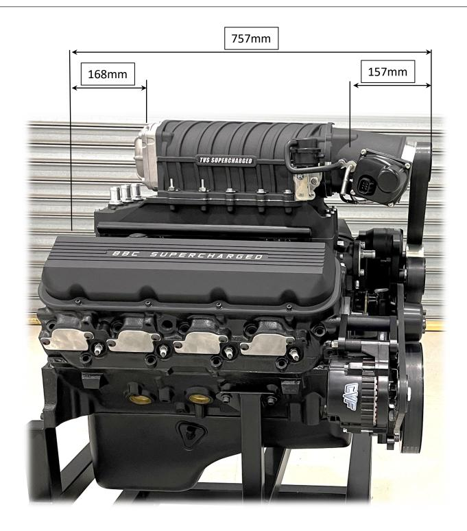
157mm FRONT OF LEFT CYLINDER HEAD TO FRONT OF 10PK PULLEY 757mm REAR FACE OF ENGINE BLOCK TO FRONT FACE OF S/C PULLEY 168mm REAR FACE OF ENGINE BLOCK TO REAR OF S/C
